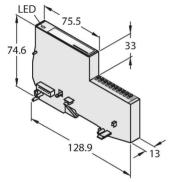
TBEN-S2-4IOL 6814024 Compact multiprotocol I/O module, 4
